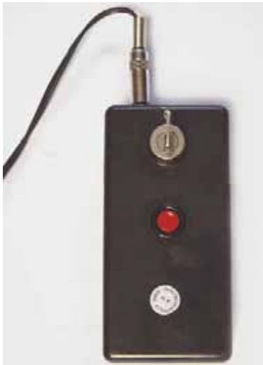
Abb. 20: Batteriebetriebene Zündvorrichtung für Kanone mit elektrischer Zündung
