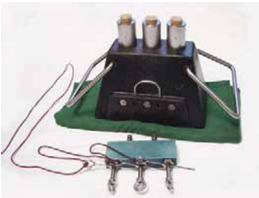
Abb. 21: Dreirohriger Standbölller mit mechanischer Zündung und Abzugsleine
