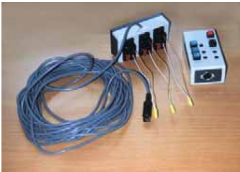
Abb. 24: Batteriebetriebene Zündvorrichtung für 3-rohrigen Standböller (Foto: Herr Nögler, Fa. Frankonia)
